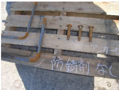
防製剤効果:摩擦増大用マットアンカーピン
