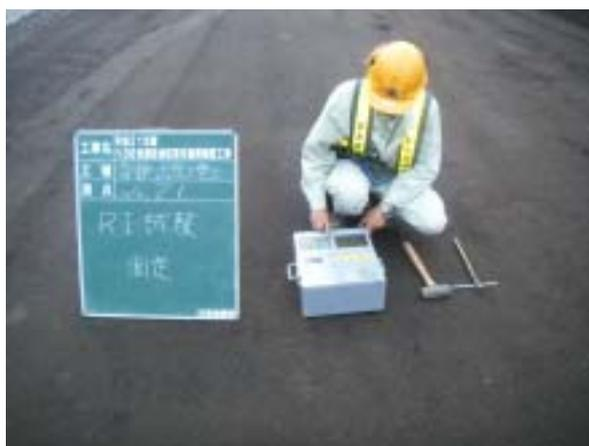
RI 計器を用いた締固めの密度管理
