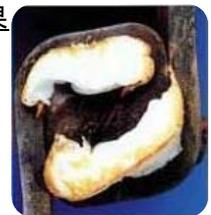
また、一度塗布されたパイルロックNSは、雨水等により膨張してしまうため、運搬・現場仮置き時のシート養生は徹底した。
