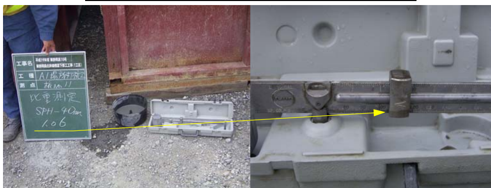
A1場所打杭工 杭NO.11 SPH-40m比重測定
