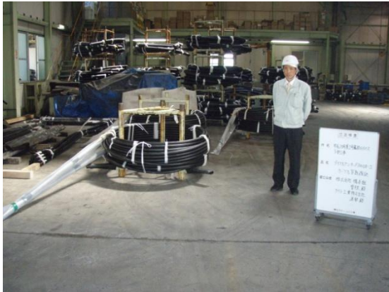
長アンカー材料(工場検査)
