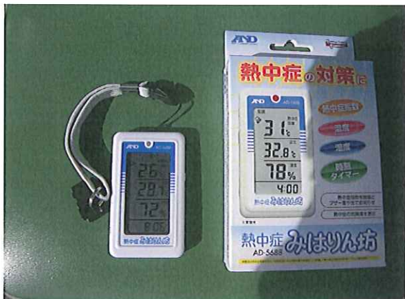
※1. 熱中症指数WBGT値測定器(左)と、現場休憩所の外から見えるよう掲示した測定結果とその対策(右)
