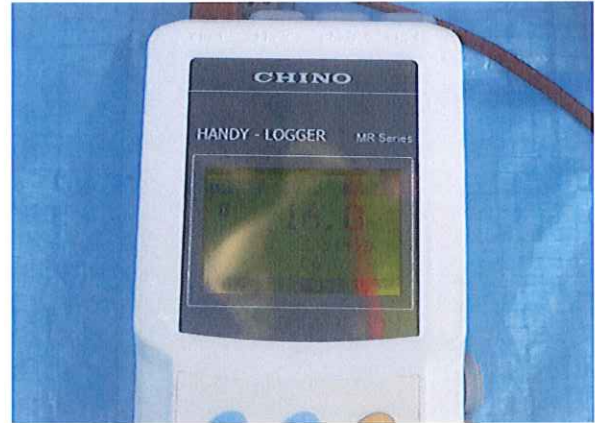
【コンクリート温度計測状況】
