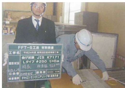
写真1 更生管周長確認
