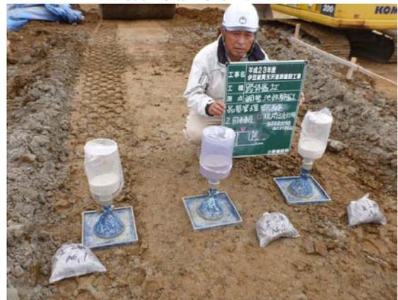
また、盛土下部まで所定の品質が確保できているか確認を行うため、転圧完了後H=0.7m掘削し、下部H=0.3mの品質試験を実施した。
