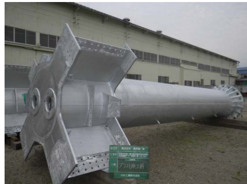
【柱材と支口部材を工場溶接で一体化】
