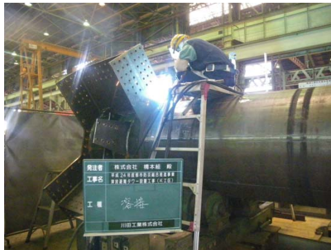
【柱材と支口部材を工場溶接で一体化】
