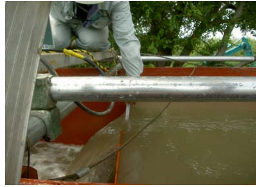
ノッチタンクにて三角堰測定
