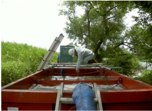
ノッチタンクにて三角堰測定
