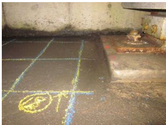
桁と橋台部分の鉄筋探査
