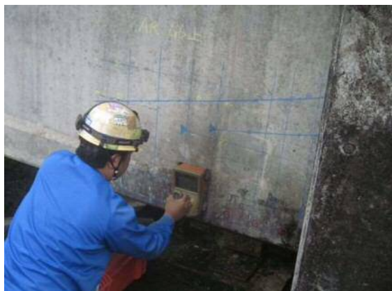
桁と橋台部分の鉄筋探査
