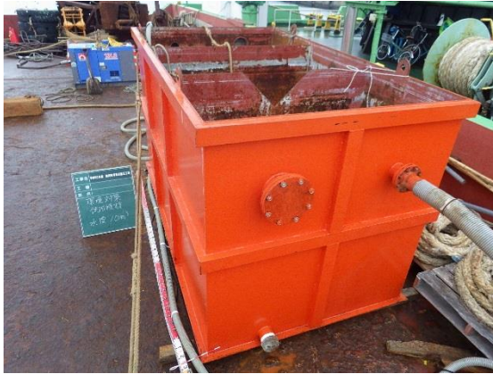
(ろ過水槽 (ノッチタンク))
