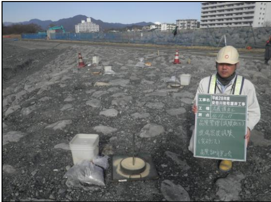
写真-7 突砂法を用いた現場密度試験
