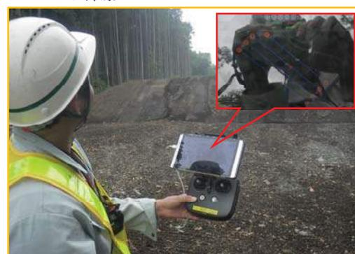
○計測点群データ、出来形計測データの作成
