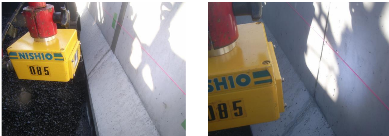
アスファルトフィニッシャーセンサー
