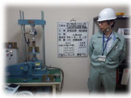
一軸圧縮試験状況
