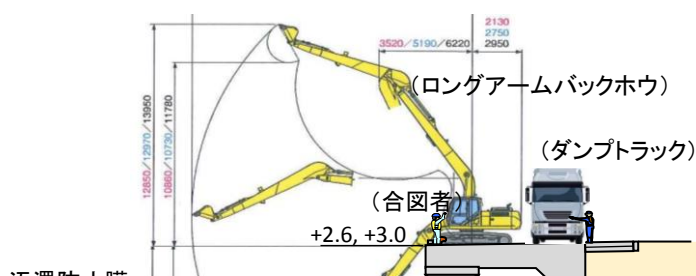
ロングアームバックホウによる撤去作業図
