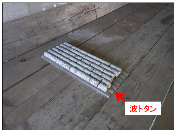
写真：波トタンを使用してコアの仮置き状況
