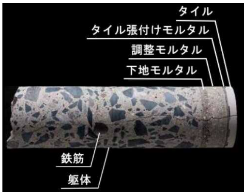
図 - 4 IPH 工法施工後に採取したコア
