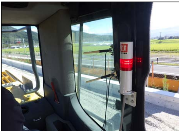
重機内のパトランプ
