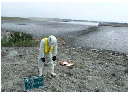
図3-1. コーンペネトロメーター試験写真及び結果
