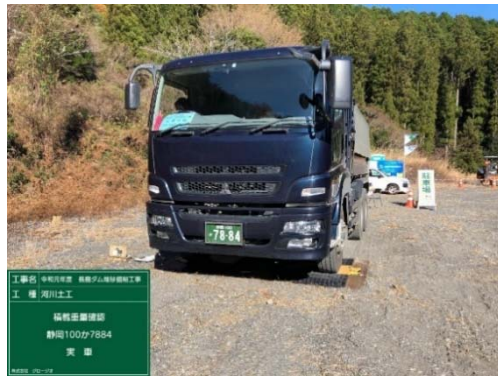
ダンプ総重量確認（トラックスケールによる）
