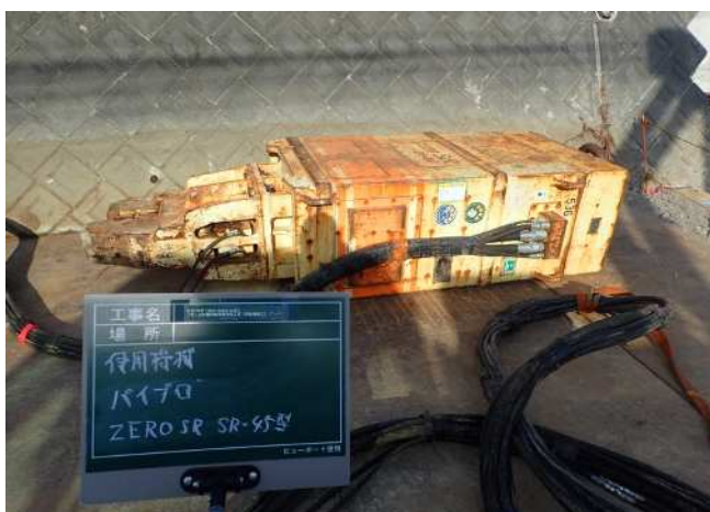
低騒音・超低騒音油圧パイプロ242 kW
