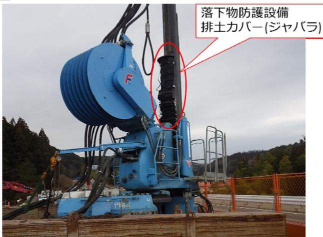
俯角75°の落下物防止対策として、ジャバラ排土カバーをクラッシュパイラーのケーシングオーガに設置した。これによりオーガによる掘削中の排土や、オーガ引抜き時にケーシングについた泥等の落下を防ぐことができた。
