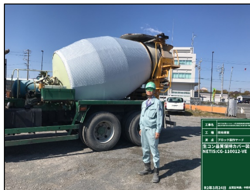
生コン品質保持カバー装着状況
