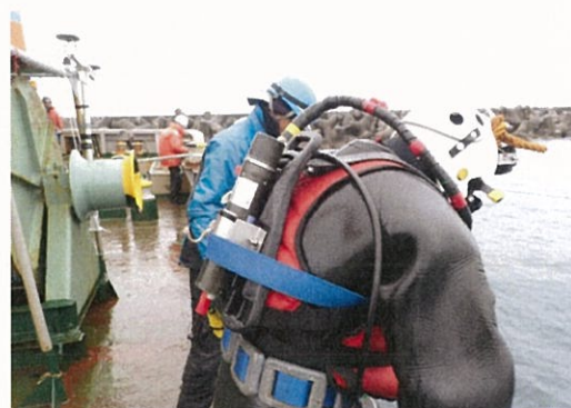
図-5 水中位置検出装置装着状況 (潜水土)
