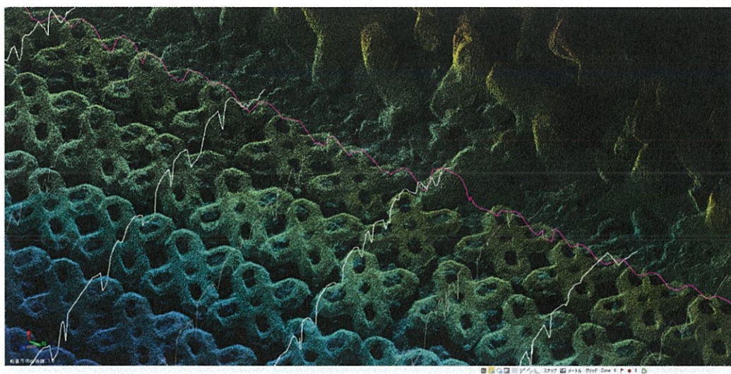
図-9 No13 付近 消波ブロックを考慮しての設置状況 (ピンク線は設計の被覆ブロック設置法線)
