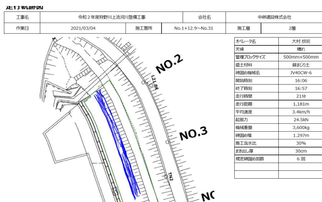
※下図：GNSSを用いた盛土の締固め回数管理における帳票（左：走行軌跡図、右図：締固め回数分布図）
