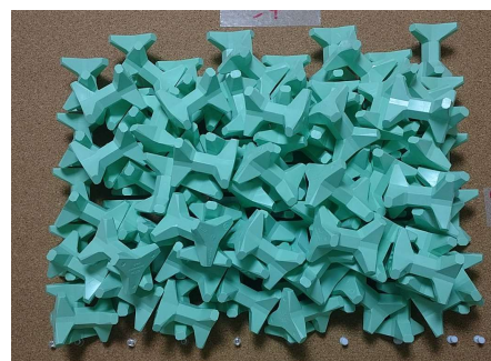
図 4 模型による据付検討
