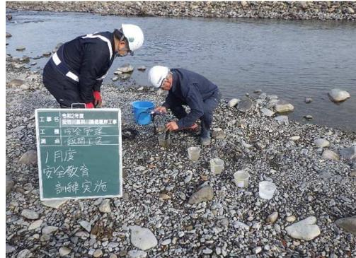
写真-8 濁度計測状況 (安全教育)
