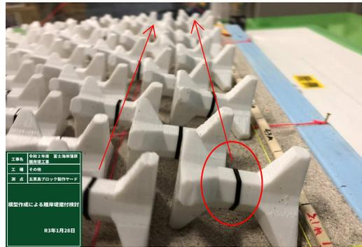
現場での製作完了ブロックへの補助線描き
