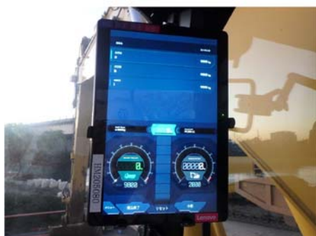
資料5, パイロード掘削機(土砂重量測定機能付きバックホウ)
