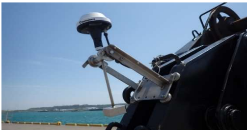
①クレーントップGNSSセンサー
