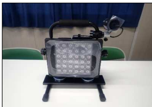
ドライブレコーダー一体型超高輝度LED警告灯(ピカドラ)
