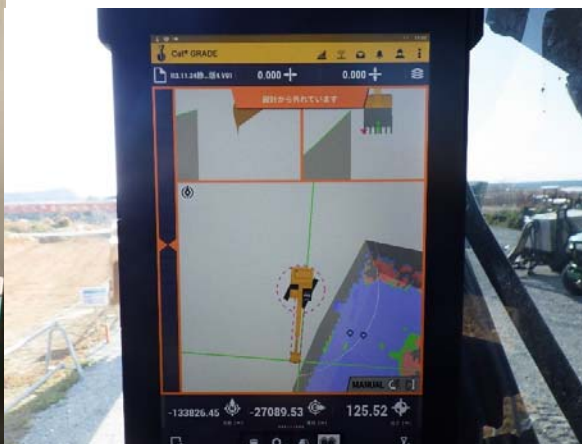
バックホウモニター上作業状況
