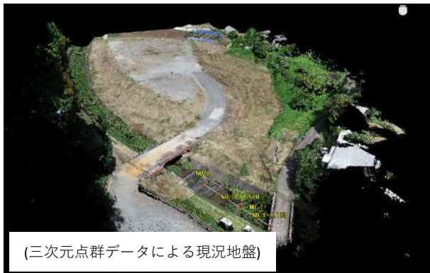
【UAVを用いた測量】
