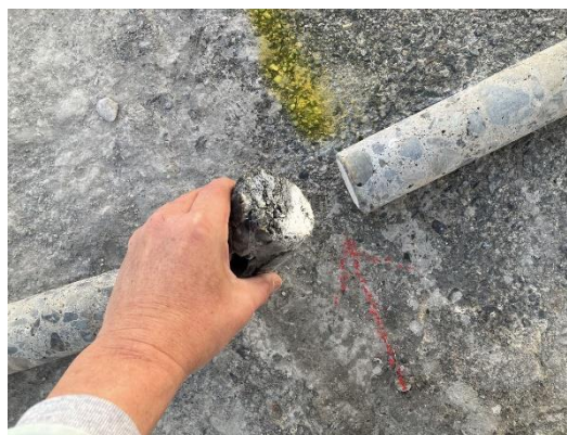
コンクリート施工継目部分(コア削孔完了後)
