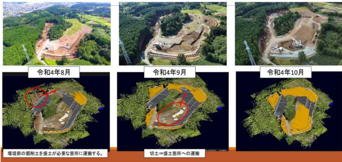
図-3. 施工履歴データによる進捗率の確認
