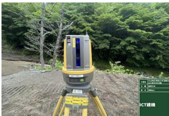
写真-2 自動追尾型測量器(杭ナビ LN-150)
