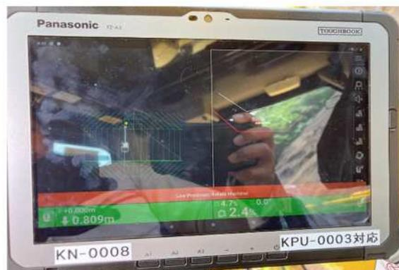
写真-6 杭ナビショベルによる施工状況②
