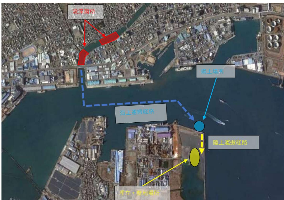
二級河川巴川河口部(羽衣橋～港橋までの区間)においてバックホウ浚渫船にて河床の掘削を行い、土運船に積込んだ土砂を海上運搬し、貝島廃棄物処理場にてバックホウ揚土をし、背後地まで陸上運搬し埋立を行う工程である。
