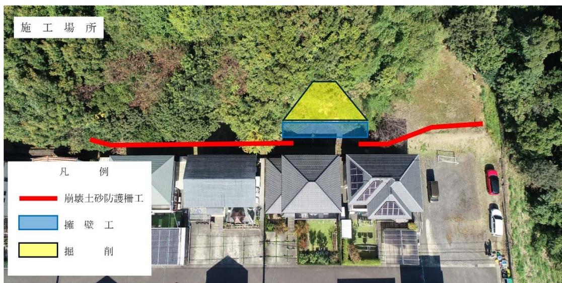
上記写真のとおり、工事箇所は住宅の真裏である。施工する崩壊土砂防護柵の支柱芯は官民境界からの離隔が  $2.20\text{m}$  と近接している為、住宅等構造物に対しての防護措置や支柱施工時に用いる大口径ボーリングマシンのヤード確保、掘削作業時には重機足場や、発生土の仮置き場の計画などが必要であった。
