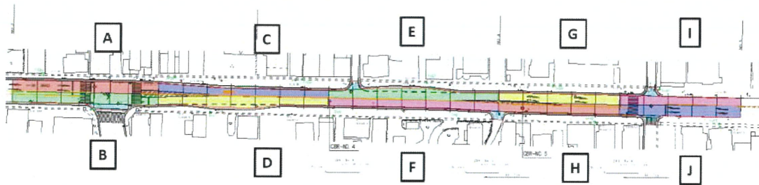
図 5.施工・規制範囲のブロック分け
