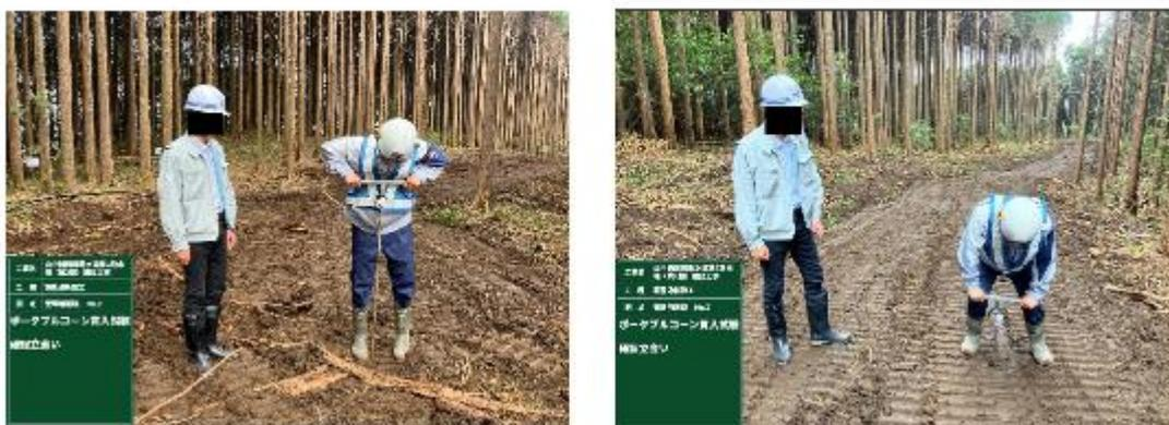
今回の試験結果により、現状土のコーン貫入抵抗値は概ね  $400\text{kN/m}^2 \sim 800\text{kN/m}^2$  であり、これは「第 3 種建設発生土」に分類されることが判明した。さらに、目視による土質確認で「粘性土」であったことも、「第 2 種建設発生土」には適合しないが「第 3 種建設発生土」には適合するという判断を裏付けるものであった。
