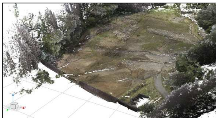
レーザースキャナーを利用した点群データの取得
