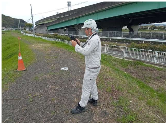
Quick3D を利用した測量状況
