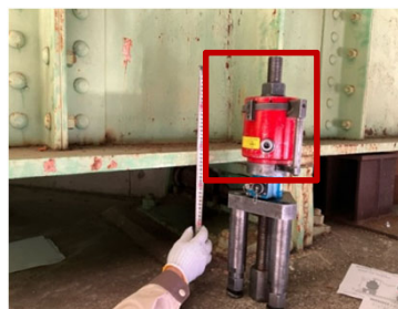
アンカーボルトの引抜試験器
